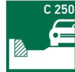
Серия Open Slot из полимербетона со стальными трапами класс нагрузки C250 – это уникальное решение для отвода сточных вод от водосточных труб. Лоток укладывается в плиточном покрытии пешеходной части, чтобы организовать перелив стоков от трубы.
