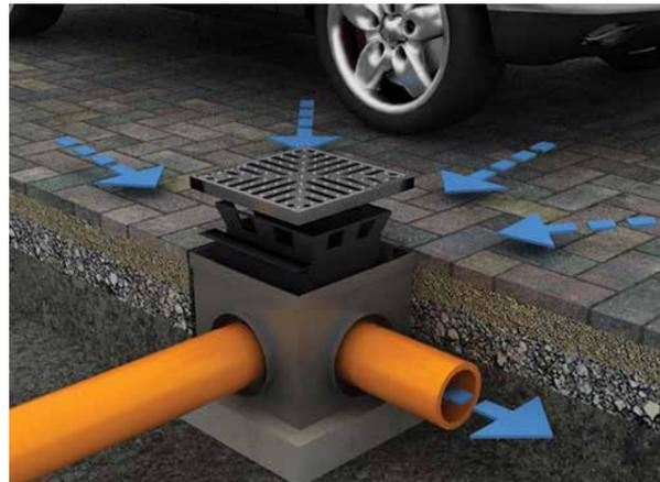
**Точечный водоотвод** выполняет либо функцию локального сбора воды, в случае если вертикальная планировка объекта не позволяет отвести воду лотками, либо – ревизионного колодца, который обеспечивает доступ к закрытым сетям канализационных труб, выполняет функцию пескоуловителя. Также система точечного водоотвода активно применяется при сборе дождевой воды, поступающей в дождеприемник по водосточным трубам.
