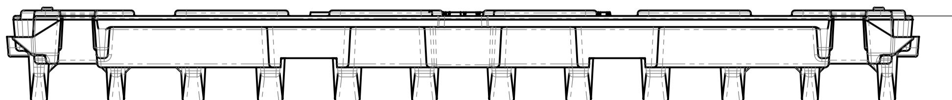
1. Площадь водозадорных отверстий решетки 1160 см кв
