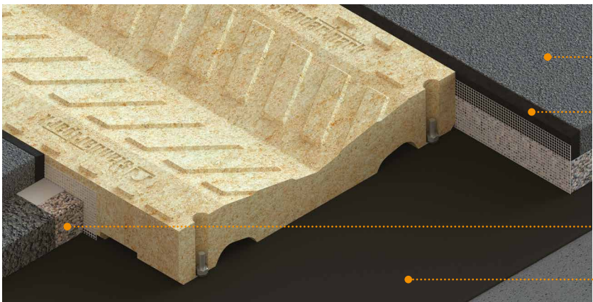
Схема монтажной сборки лотков Somromax
