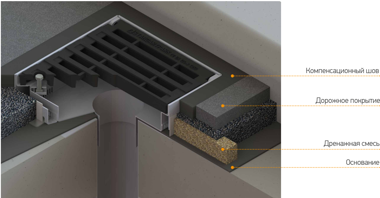
Схема монтажной сборки трапа SteelMax
