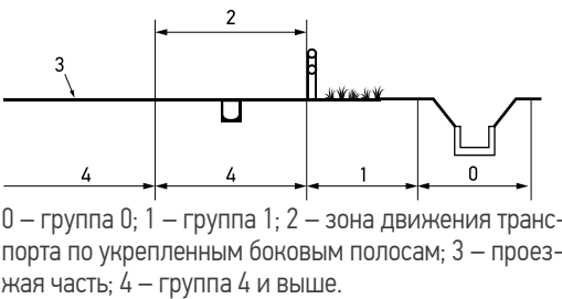
Рис. 2 Типичные детали боковых полос с представлением некоторых групп установки лотков
